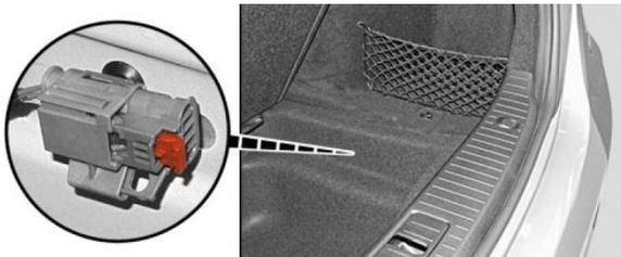
Unter der Abdeckung der Kofferraummulde hinten rechts befindet sich die Hochvoltabschaltvorrichtung. Die Muldenverkleidung wird an der Zuglasche unterhalb der Ladekante in der Fahrzeugmitte aus dem Kofferraum gezogen.
