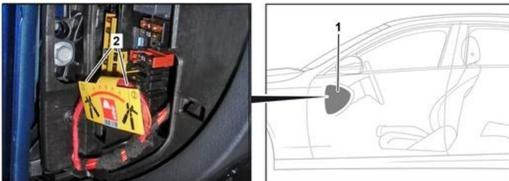
Abdeckung (1) entfernen. Leitung an der markierten Stelle (2) durchschneiden.
