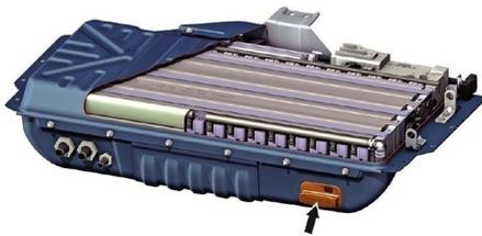
Le dispositif de coupure haute tension se trouve accolé à la batterie haute tension, à droite à l'arrière, vu dans le sens de marche.
